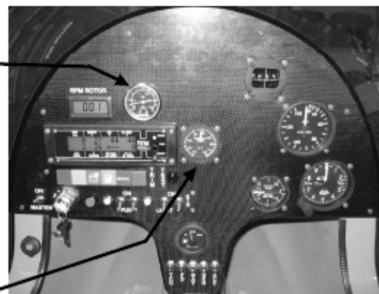
FIG. 2.12/3 INDICATORE PRESSIONE DI ALIMENTAZIONE FUEL SUPPLY PRESSURE INDICATOR
